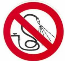
**Nettoyage à la fin de la saison :** Rincer l'appareil à l'eau chaude, comme décrit ci-dessus. En outre : Éventuellement, dévisser le filtre et nettoyer le tamis. Le bouclier et le carter de la buse peuvent être nettoyés au moyen d'un chiffon humide ; ne pas toucher le disque de la buse afin d'éviter tout dommage. En cas de fort encrassement, dévisser le carter de la buse et éliminer les saletés, ainsi que les morceaux de plantes. Raccorder l'appareil au chargeur (voir plus bas).
